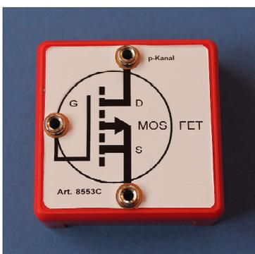
**MOSFET, p-Kanal, – 55V, – 12 A, Typ IRF9Z24NPBF**
